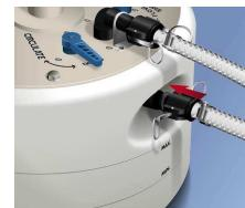
7.3. Osigurajte da se odvodno crijevo i crijevo za prelijevanje ispuštaju na nižoj točki od mjesta za ispuštanje na Powerflow Flushing Machine MKIII. Ako to ne napravite, može doći do prelijevanja spremnika pumpe. Ako je potrebno, pumpa može biti povиšena kako bi se povećao pad vode u tim crijevima. Trebate paziti da pumpa bude stabilna.
